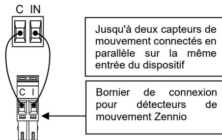
Jusqu'à deux capteurs de mouvement connectés en parallèle sur la même entrée du dispositif
