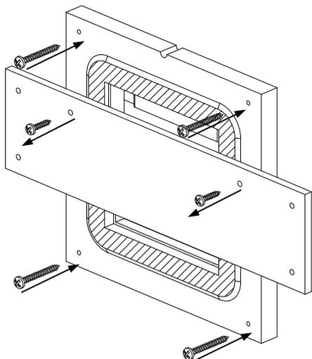
**4** Réalisez les travaux de plâtrage en évitant la *surface affleurante*. Une fois sec, vous pouvez effectuer les travaux de peinture et de finition du mur (en évitant de peindre la *partie intérieure de l'accessoire*).
