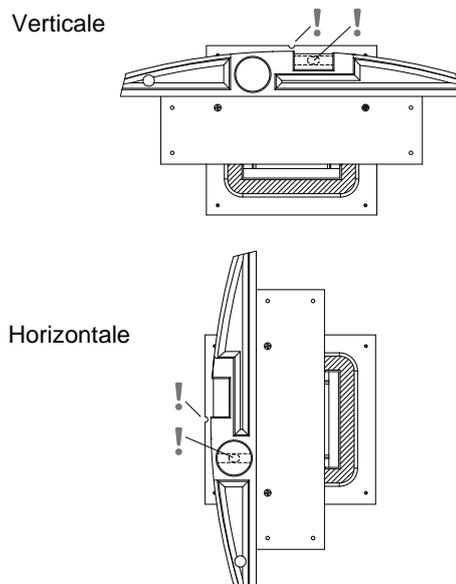
**3** Fixez l'accessoire aux guides de mur au moyen des vis adéquates (non incluses). Une fois fixée, vous pouvez retirer la *pièce auxiliaire de montage* avec ses quatre vis.
