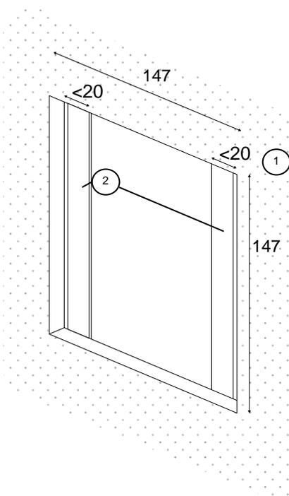
**2** Placez l'accessoire dans le trou et, à l'aide d'un niveau, ajustez sa position horizontale (ou verticale) exacte.
