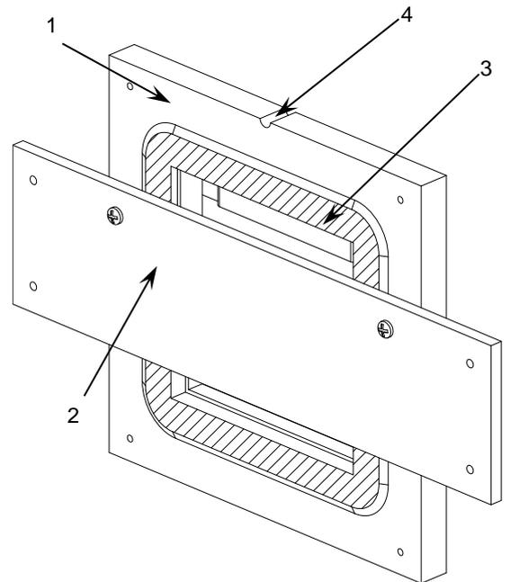
1. Accessoire pour installation au ras du mur    2. Pièce auxiliaire de montage (jetable)    3. Surface au ras du mur    4. Marque de position
