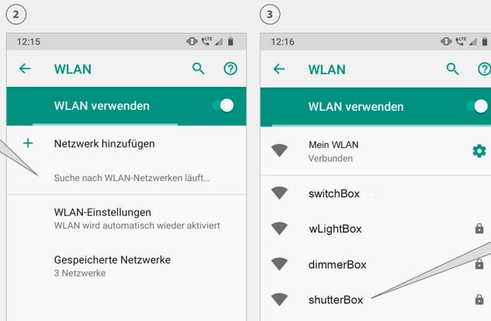
Wählen Sie das vom Steuermodul generierte WLAN-Netzwerk aus
