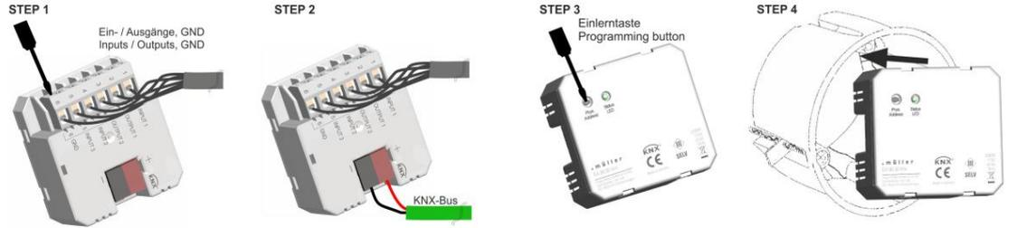
**Montage-Hinweis:** Beim Platzieren des Gerätes in der Unterputzdose darauf achten, dass keine Leitungen eingeklemmt oder gequetscht werden.
