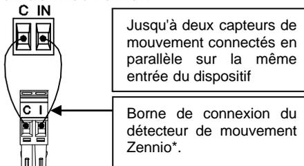
Jusqu'à deux capteurs de mouvement connectés en parallèle sur la même entrée du dispositif
