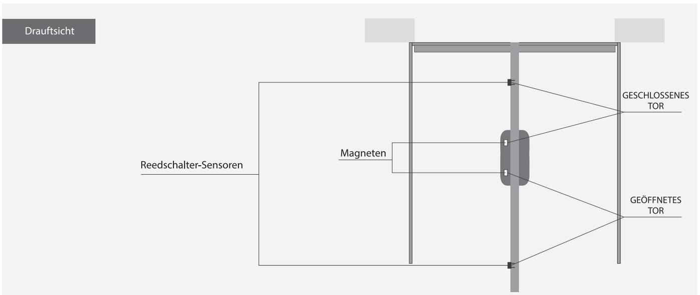
**BEISPIEL FÜR DEN ANSCHLUSS VON REEDSCHALTERN AN EIN SCHIEBETOR**
