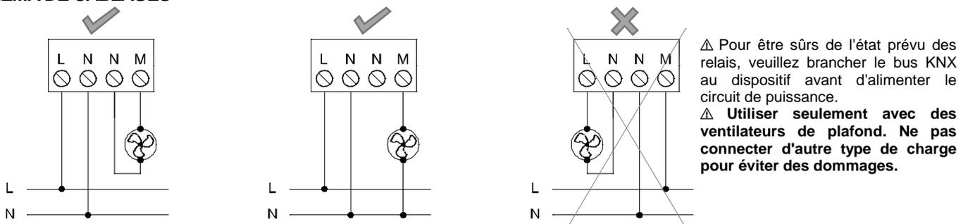
Figure 2: Diagramme de connexion d'un ventilateur
