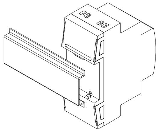
Figure 3: Montage du dispositif sur rail DIN
