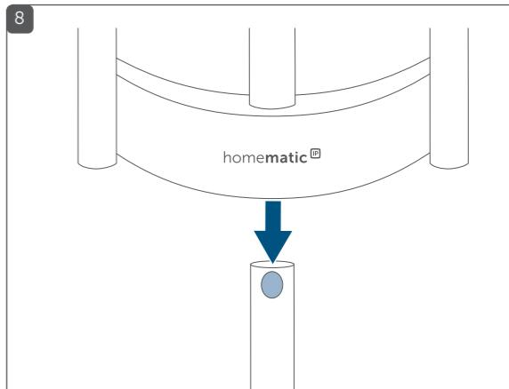
► Achten Sie darauf, dass die Einkerbungen der einzelnen Rohre übereinander liegen. Der Wetersensor wird auf das mit einem Aufkleber markierte Rohrende aufgesteckt.
