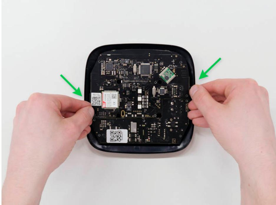
7. Ziehen Sie die (kleinere) Netzteil-Platine von der Hauptplatine ab.
