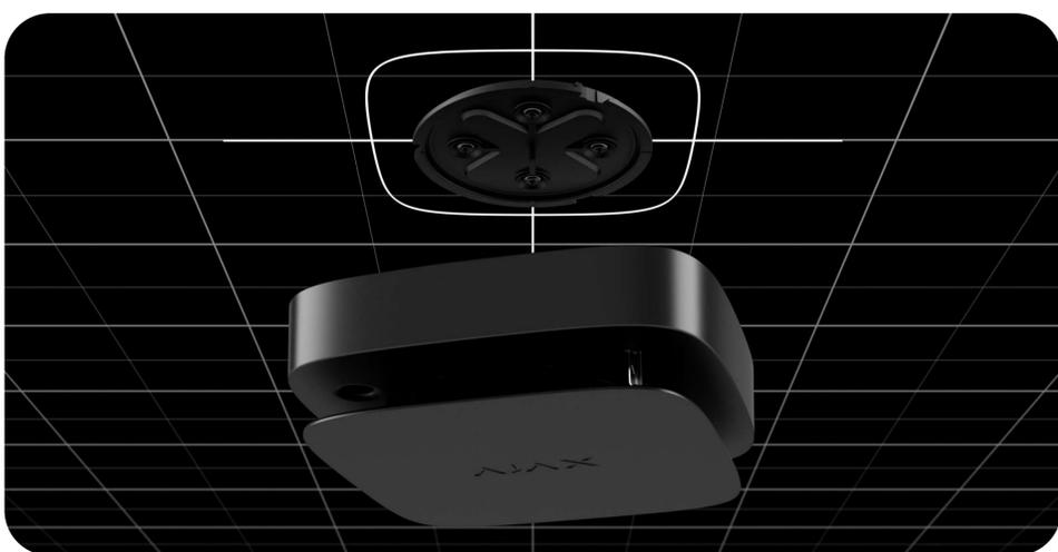
Pour installer le FireProtect 2, il n'est pas nécessaire de démonter le boîtier du détecteur. Les batteries remplaçables ou non sont préinstallées et le support SmartBracket se retire du détecteur sans outils. Le panneau de montage SmartBracket a un degré de liberté de 90°. Cela permet à l'installateur d'aligner la position de l'appareil après l'installation.
