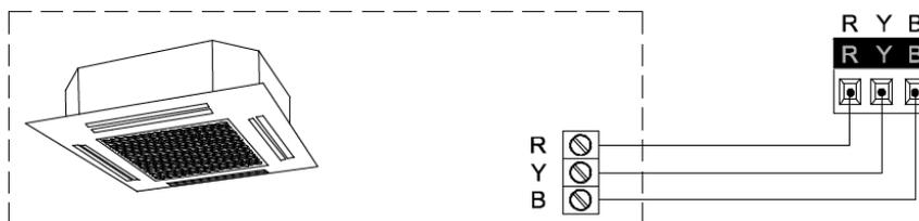
Figure 2. Connexion du KLIC-LG1 à la machine d'A/C.
